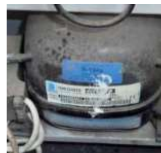
Kompresor chladničky s chladivom R134a
