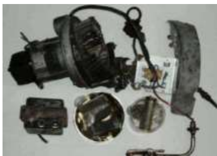
elektromotory s nebezpečnými látkami (napr. PCB štartovací kondenzátor)
