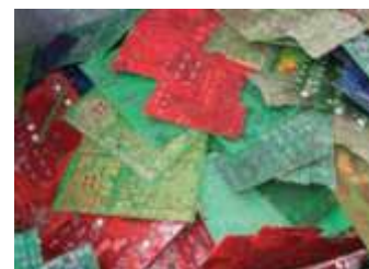
leptaná doska plošných spojov, nezaplnená
