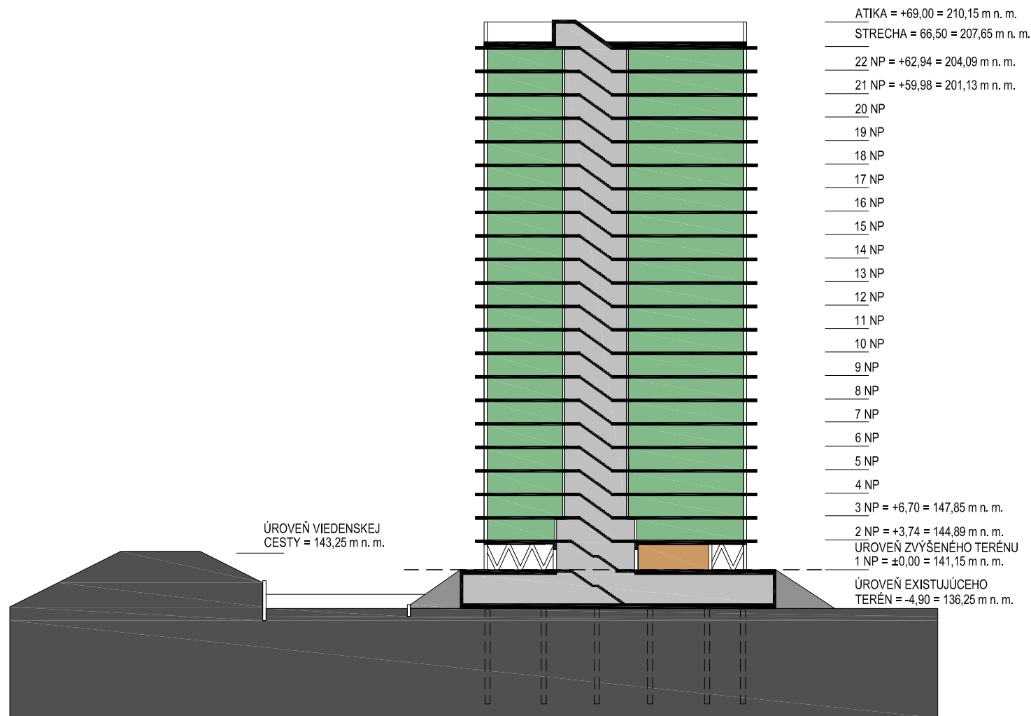
REZ ADMINISTRATÍVNOU BUDOVOU A, B
