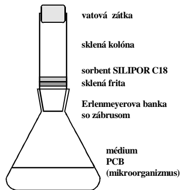
Obr. 10 Aparatúra na sledovanie odparu a biodegradácie PCB (Dercová a kol., 1996).
